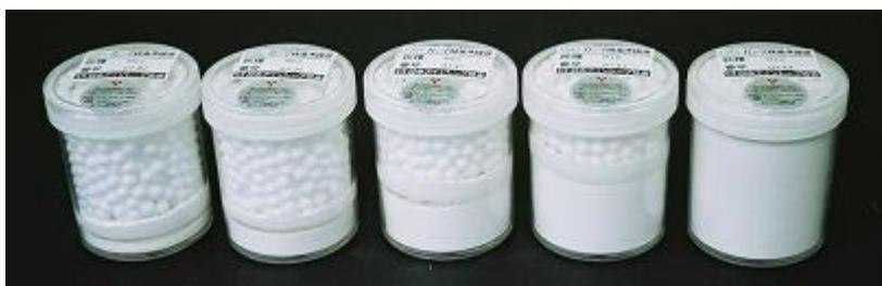
図5 放射能標準体積線源の例 (2Lマリネリ容器タイプ (左) と100mL容器 U8タイプ (右))<sup>6)</sup>
