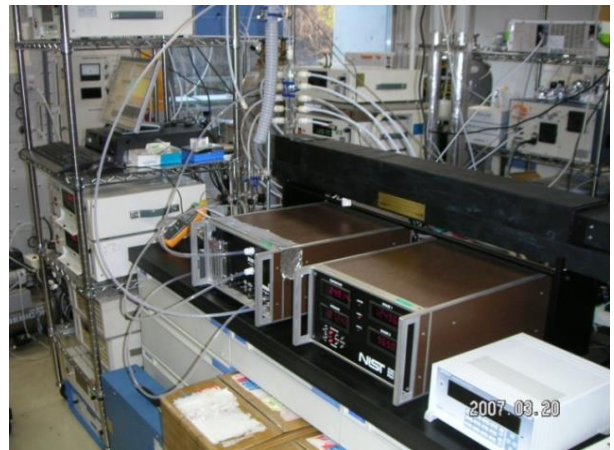
図 2 オゾン計測における一次標準器 (標準参照光度計 : Standard reference photometer)
