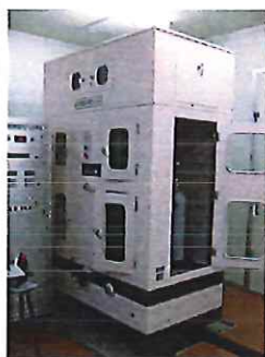
大質量超精密天秤 秤量: 30 kg、感量: 1 mg
