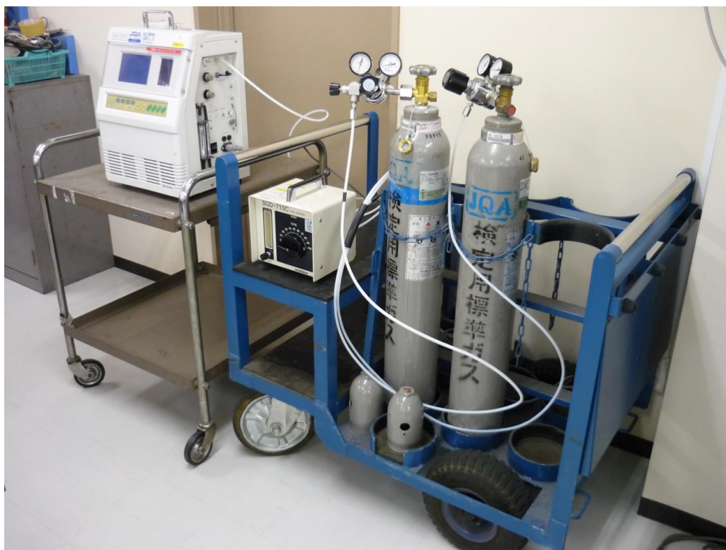
図7 器差検定の様子（大気濃度計）
