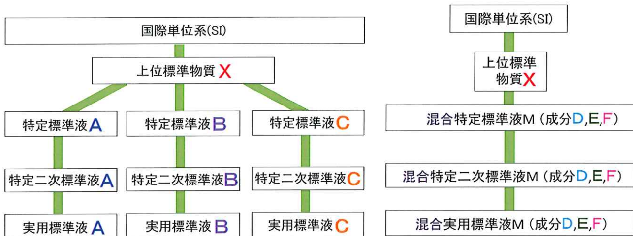
図3 一対多型のトレーサビリティ確保による標準液のトレーサビリティ体系図
