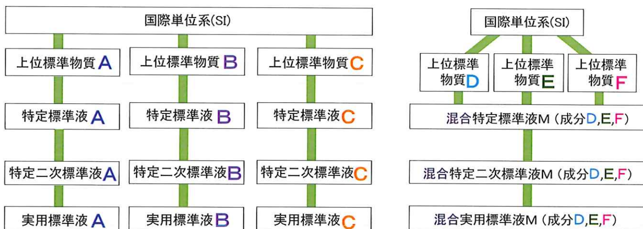
図2 一対一型のトレーサビリティ確保による標準液のトレーサビリティ体系図
