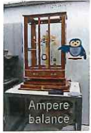
電流天秤：絶対アンペア (写真提供：国立科学博物館)
